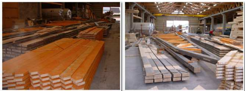
Préparation des pièces et préfabrication des demi-fermes en atelier
